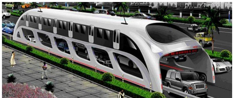
a pour ambition de créer un bus qui circulerait, sur rails, au-dessus de la chaussée en surpassant les automobiles situées sur les deux voies. Ainsi, plus de problèmes de circulation et plus besoin de créer des voies dédiées aux autocars.
