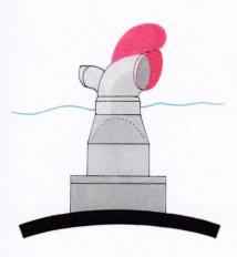
Le vent actionne des girouettes mobiles placées sur des bouches d'aération où l'air s'engouffre.
